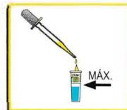
1. Retirer le couvercle du tube et à l'aide de la pipette, remplir le tube soigneusement avec l'huile chaude (moins de 120°C), jusqu'au bord de l'autocollant avec l'échelle de couleurs.
