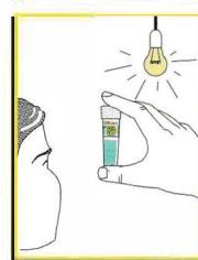
3. On interprète les résultats en soutenant le tube verticalement, 2 minutes après l'homogénéisation, directement vers la lumière.
